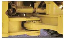
Knickgelenk. Die stark gespreizte Konstruktionsform des Knickgelenks reduziert nicht nur die Lagerbelastung, sondern schafft auch viel Platz für Servicearbeiten. Obere und untere Doppelkegelrollenlager nehmen die vertikalen und horizontalen Kräfte auf und verteilen sie auf eine große Kontaktfläche.
