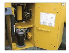
Hydraulik-Servicezentrum. Getriebeölund Hydraulikölfilter wurden in einem Hydraulik-Servicezentrum hinter der ausklappbaren rechten Leiter zusammengefasst. Von dieser Stelle aus kann auch der Hydrauliköltank entleert werden. Die empfohlenen Filterwechselintervalle:
