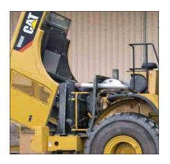
Motorraumzugang. Nicht nur die Kontur der Kunststoff-Motorhaube wurde verändert, sondern auch die Ober- und Seitenteile mit zusätzlichen Versteifungsrippen versehen. Beide Maßnahmen verbessern Stabilität und Dauerhaltbarkeit der Haube. Seitenklappen hinter den Reifen lassen sich hochschwenken und bei Bedarf komplett abnehmen. Die ausschwenkbaren großen StVZO-Kotflügel sind hinten angelenkt und erleichtern dadurch den Zugang zum Motorraum.
