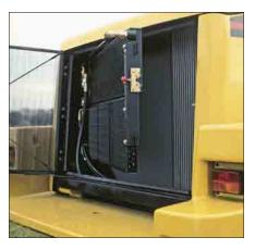
**Kühlsystem.** Ein feinmaschiges, gewelltes Siebgitter vermindert die Verstopfungsgefahr und kann zum Reinigen der Kühlernetze nach links geschwenkt werden.
