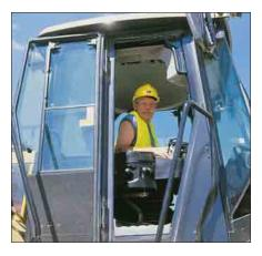
Fahrerkabine. Das Abbauen der Fahrerkabine ist dank Steckverbindern an den Stromkabeln und Schnellverschlusskupplungen an der Klimaanlage ohne jeglichen Kältemittelverlust innerhalb von 45 Minuten zu bewerkstelligen. Auch das Reinigen der Kabine wird durch Bodenrinnen und schwellenlose Türöffnungen wesentlich vereinfacht.
