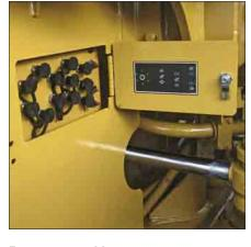
**Fernmessanschlüsse.** Hinter einer Klappe befinden sich die Messanschlüsse für Brems-, Lenk- und Arbeitshydraulikdrücke.
