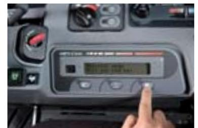
1 Stecken Sie den roten Schlüssel in das Zündschloss und drücken Sie anschließend den rechten Menüschalter mit dem Bildschirmsymbol.
