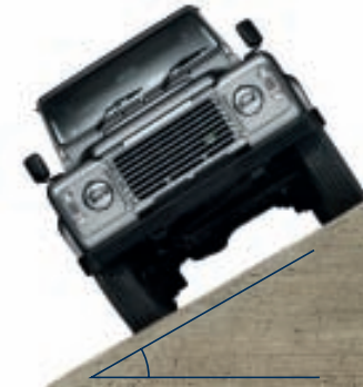
Maximale Seitenneigung abhängig von der Zuladung
