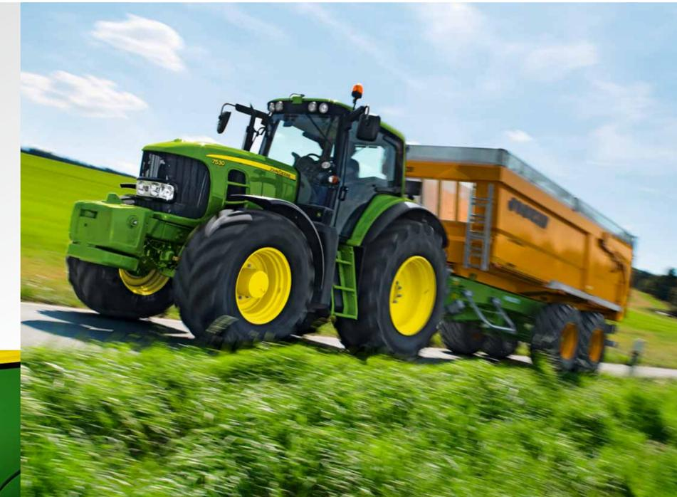
**Der völlig neue Traktor 7030 E Premium** ist der erste und einzige Traktor mit integriertem elektrischem Generator zum Antrieb von Nebenaggregaten, wie Lüfterantrieb sowie Klima- und Druckluftkompressor. Die Motorleistung lässt sich so wesentlich effizienter umsetzen. Die E Premium Baureihe bietet auch 300-A-Strom für alle anderen 12-V-Systeme von Traktor und Arbeitsgeräten.
