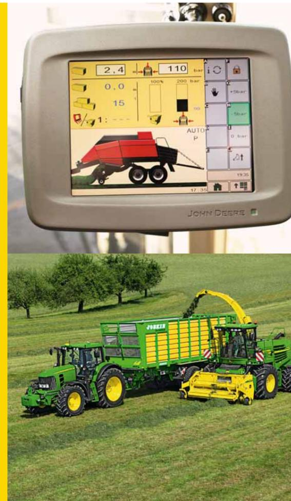
**ISO-kompatible Geräte steuern leicht gemacht:** mit dem Monitor GS2 mit Farbanzeige als Wahlausrüstung.
