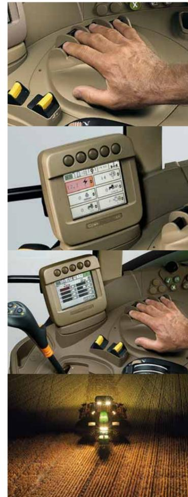
**Mechanische (wahlweise mit Kreuzhebel) oder elektrohydraulische Steuergeräte.** So steuern Sie bis zu sechs Steuergeräte präzise, sicher und bequem.
