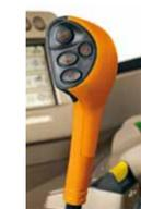
**Der neue Kupplungsknopf auf dem Schalthebel** ermöglicht ein Schalten der Gänge, ohne die Kupplung zu treten. So wird das Fahren der Getriebevarianten PowrQuad Plus und AutoQuad Plus noch komfortabler.
