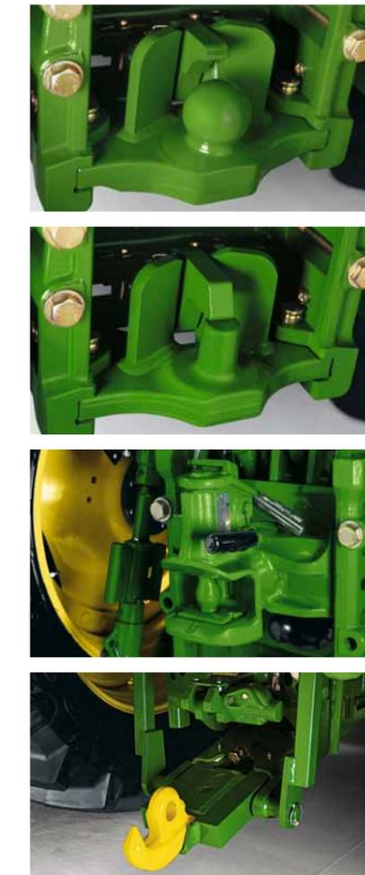
**Ganz schön vielseitig.** Sie können das innovative 3-in-1 Anhängesystem mit unterschiedlichen Anhängervorrichtungen einsetzen, von der Anhängerkupplung über die Kugelkopfanhängung bis hin zur Piton-Fix-Anhängung. Ganz gleich, mit welcher Anhängung Sie arbeiten wollen, ein schneller, werkzeugloser Wechsel der Anhängung ist immer möglich.
