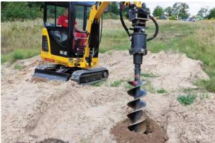
Erdbohrgerät für 301
