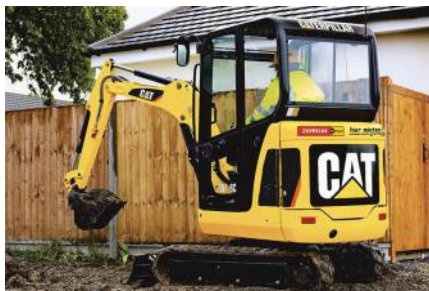
Minibagger CAT 301.8C (1,8 t) von Caterpillar
