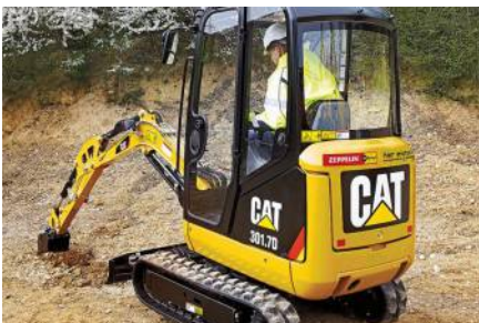
Minibagger CAT 301.7 D (1,8 t) von Caterpillar
