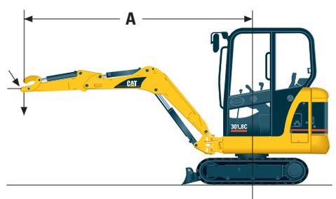
\* Die maximale Hublast wird eher durch die Hydraulikkraft als durch die Standsicherheit begrenzt. Die angegebenen Nennlasten basieren auf SAE J1097 und betragen maximal 87% der hydraulischen Hubkraft oder 75% der Kipplast. Alle Werte verringern sich um das Gewicht des verwendeten Hebezeugs.
