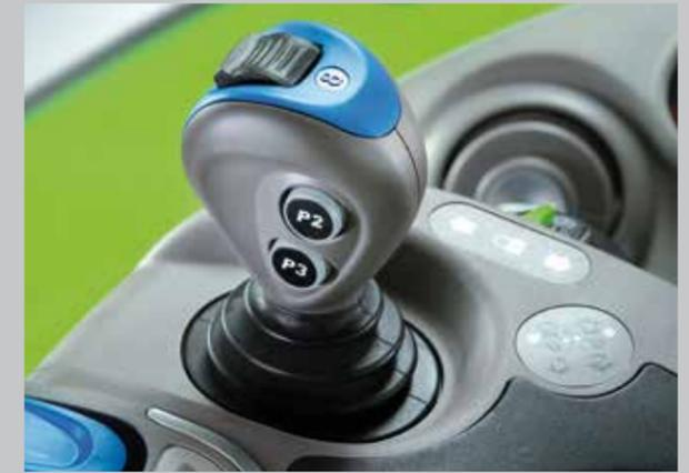
Die Hydraulikventile sind proportional steuerbar und voll auf Zeit und Menge programmierbar. Der elektronische Joystick kann programmiert werden um den Frontlader zu bedienen, weitere Steuerventile können über das Rändelrad bedient
