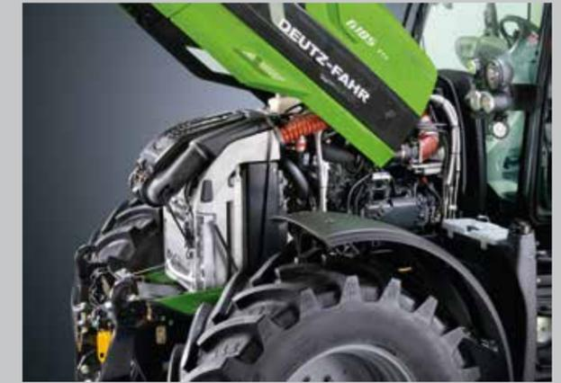
Hoch wirksames und kompaktes Kühlsystem mit Ladeluftkühler, Wasserkühler, Getriebeölkühler, Kraftstoffkühler und Kondensator.
