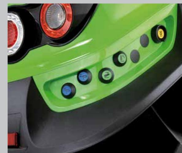
Hydraulik, Heckkraftheber und Zapfwelle lassen sich extern von jeder Seite aus leicht bedienen.
