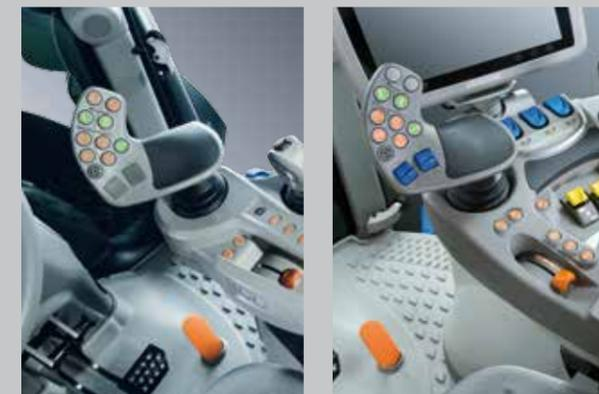
RCshift. Variante mit mechanischen Steuergeräten und Variante mit Multifunktionsarmlehne, elektrohydraulischen Steuerventilen und iMonitor
