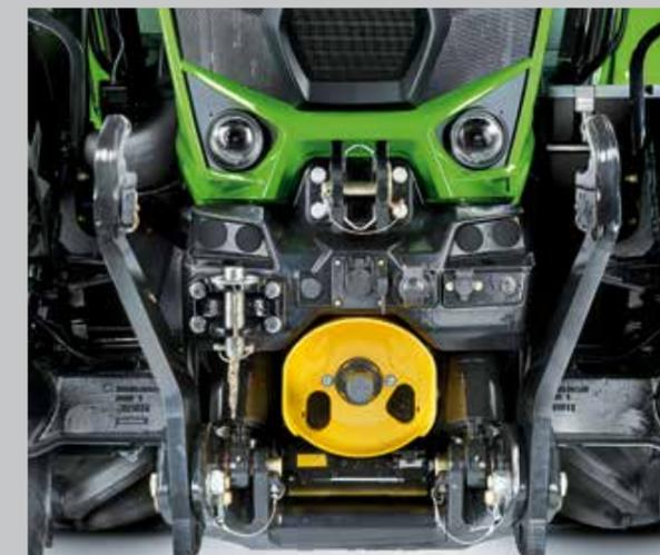
Neuer positionsgesteuerter Frontkraftheber (TTV-Modelle) mit bis zu 5.480 kg Hubkraft.
