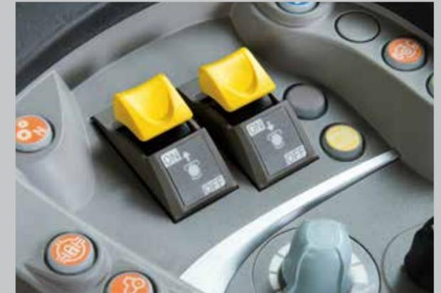
Bei allen Kabinenausführungen erfolgt die Zapfwellschaltung standardmäßig einfach und sicher per Tastschalter.
