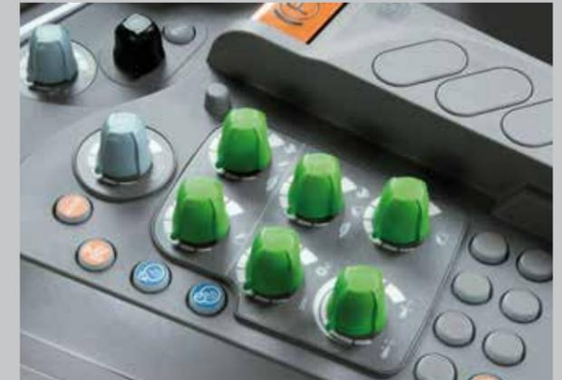
Die Feineinstellung von Frontkraftheber (nur TTV) und Heckkraftheber erfolgt über entsprechende Potentiometer in der Armlehne.
