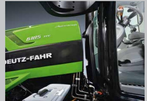
Kabine und Motorhaube sind für maximalen Komfort voneinander entkoppelt. Dies reduziert deutlich Lärm und Vibrationen.
