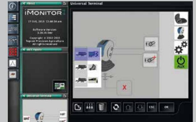
ISOBUS-Integration. Arbeitsgerätefunktionen werden über zugewiesene Traktortasten gesteuert.
