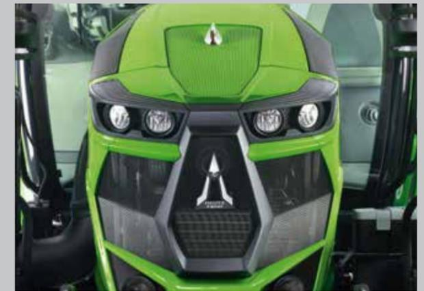
Die schlanke Geometrie der Haube ermöglicht beste Sicht auf alle Arbeitsbereiche. Serienmäßig ist die Serie 6 mit Halogenscheinwerfern ausgestattet.
