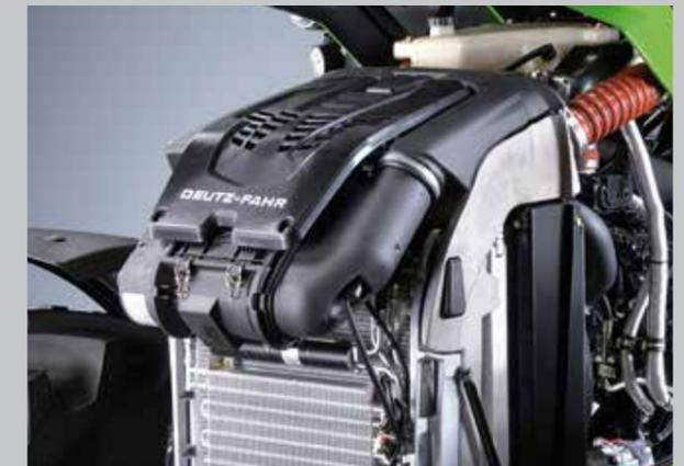
PowerCore-Technik für den Luftfilter: 20 % mehr Luftleistung im Vergleich zu Standardfiltern.
