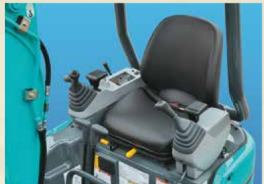
Drei-Säulen-Schutzdach gemäß ROPS und FOPS, Stufe 2
