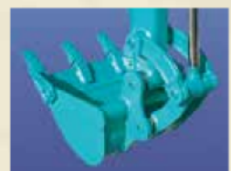
Gelenkbolzen mit Splint / Löffelschwinge aus Stahlguss
