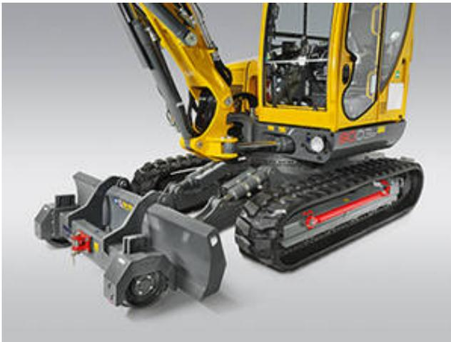
Durch das Montieren eines hydraulischen Schienenfahrwerks wird der Kompaktbagger zum 8003 railway – dem Zwei-Wege-Bagger für Arbeiten an Gleisanlagen. Klicken Sie auf "Anwendungen" um mehr zu erfahren.
