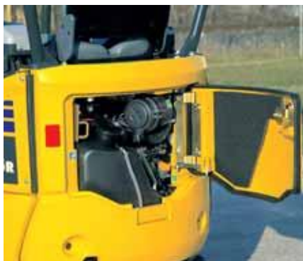
Hintere Wartungsklappe: schnelle Motorinspektion und Betankung
