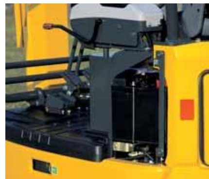
Linke Wartungsklappe: leichter Zugang zur Batterie
