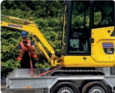
Verzurrösen am Oberwagen ermöglichen eine schnelle Transportsicherung
