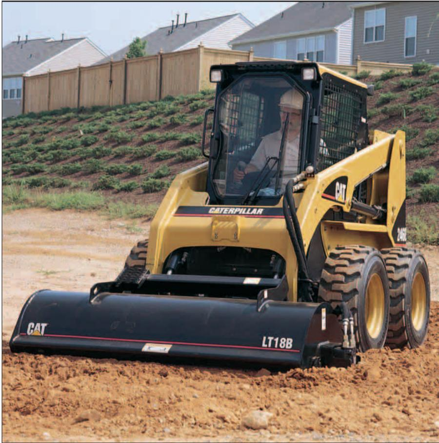
**Dieselmotor.** Mit einer Nennleistung von 37 bzw. 43 kW stellt der Cat 3024C reichlich Leistung für alle vorkommenden Einsätze zur Verfügung. Der robuste, zuverlässige und drehmomentstarke Vierzylinder, der im 226B mit Abgasturbolader ausgerüstet ist, unterschreitet die Emissionsgrenzwerte gemäß EU-Richtlinie 97/68/EG, Stufe II.
