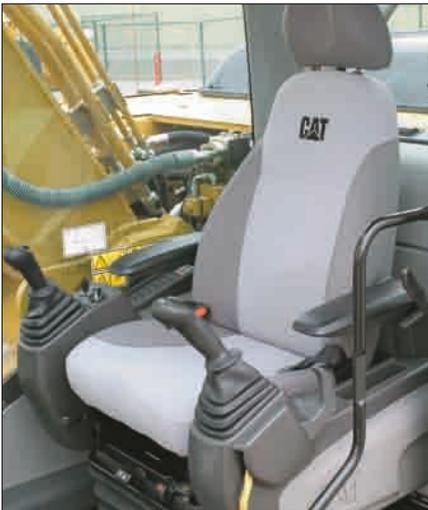
**Steuerhebelkonsolen.** Beide Steuerhebelkonsolen wurden neu gestaltet, um die Funktionalität zu verbessern und dem Fahrer ein ermüdungsarmes, produktives Arbeiten zu ermöglichen. Die in der Höhe verstellbaren Armlehnen sind direkt mit den Konsolen verbunden.
