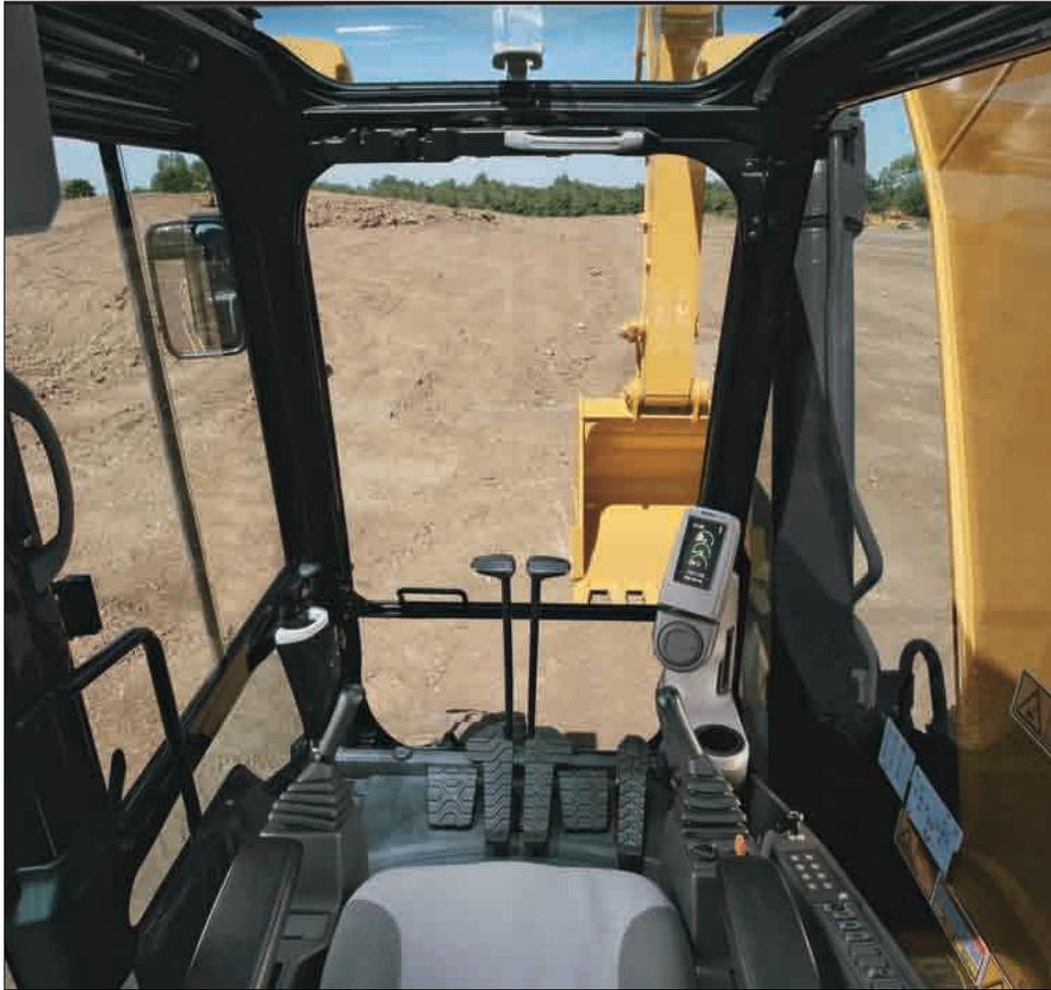
**Ergonomie.** Im Innenraum der Kabine dominieren Ergonomie und Komfort. Alle Bedienelemente befinden sich in direkter Reichweite und lassen sich mit wenig Kraftaufwand betätigen. Das neue Steuer- und Überwachungspult ist im Blickfeld des Fahrers angeordnet, ohne die Sicht zu behindern.
