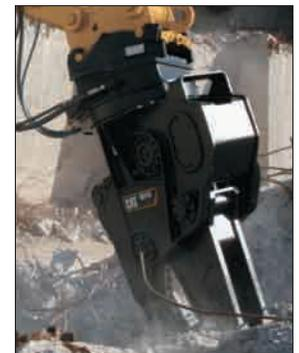
**Hydraulikhämmer.** Dank sehr hoher Schlagzahlen überzeugen Cat Hydraulikhämmer durch außergewöhnliche Produktivität bei Bau- und Abbrucharbeiten. Aufgrund der breiten Ölvolumenspanne eignen sich die Hämmer für verschiedenste Trägermaschinen.
