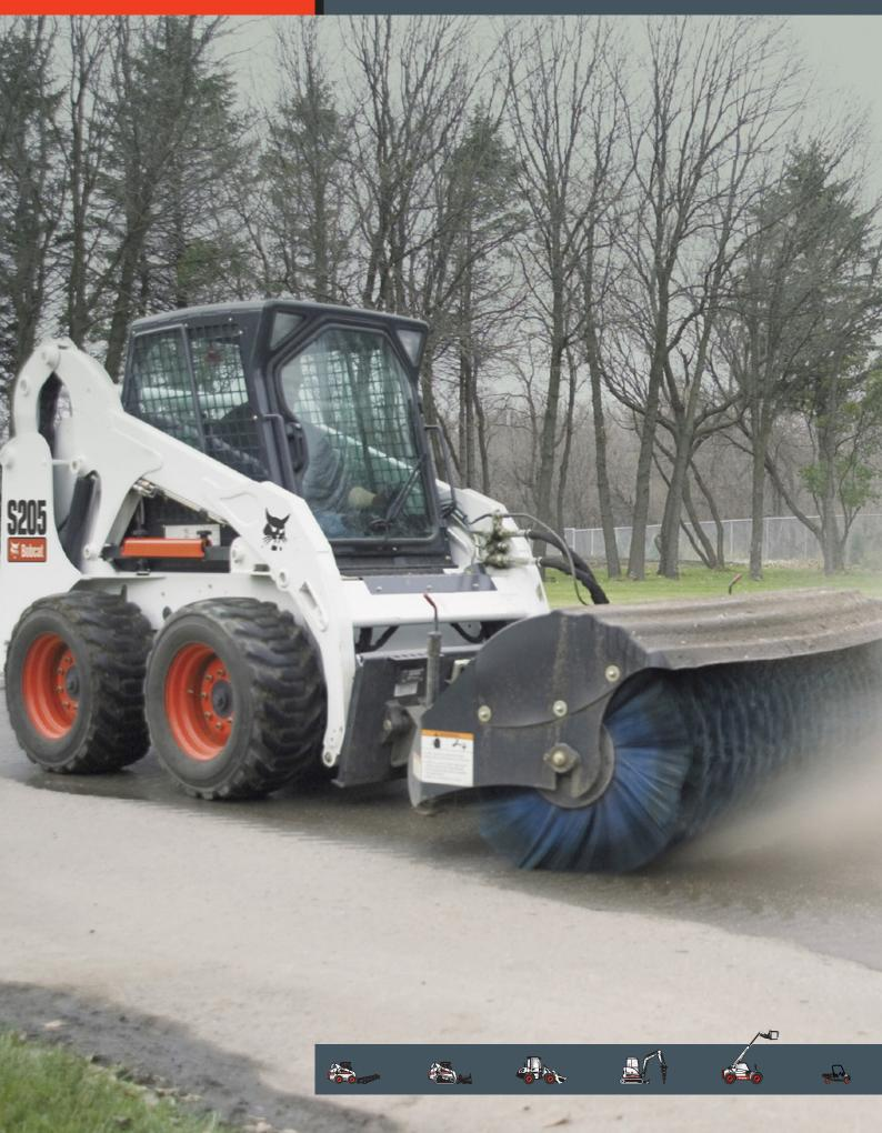
1009 kg 2019 kg Fahrbare Nutzlast Kipplast (ISO 14397-1) 62,0 l/min Förderleistung Förderleistung- Hochleistungshydraulikoption 96,5 l/min Systemdruck an Schnellkupplungen 22,4-23,1 MPa Max. Fahrgeschwindigkeit (niedriger Bereich) 0 - 11.6 km/hMax. Fahrgeschwindigkeit (hoher Bereich - Option) 0 - 18 km/h
