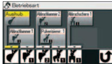
Wird das Anbaugerät ausgetauscht, kann die Ölstromeinstellung durch einen Druck auf die Arbeitsmodus-Auswahlanzeige auf dem LCD-Monitor automatisch erfolgen. Falls erforderlich, sind geringfügige Anpassungen des Ölstroms möglich.
