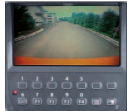
Der breite LCD-Farbmonitor zusammen mit der Heckkamera auf dem Gegengewicht gewährleistet eine gute Sicht nach hinten. Bei Rückwärtsfahrt schaltet sich die Heckkamera automatisch ein. Sie kann auch manuell über einen Schalter am Monitor aktiviert werden.
