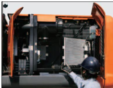
Anstatt wie bei der herkömmlichen Reihenanordnung sind Ölkühler, Wasserkühler und Zwischenkühler parallel angeordnet. Diese Parallelanordnung lässt sich wesentlich einfacher um den Motor herum reinigen. Der Klimaanlagekondensator lässt sich klappen, so dass die Reinigung des Kondensators und des dahinter befindlichen Wasserkühlers vereinfacht wird.
