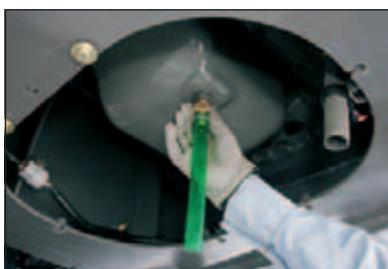
Die Motorölwanne ist mit einer Ablaßkupplung ausgestattet. Beim Ablassen wird ein entsprechender Ablaßschlauch mit der Kupplung verbunden. Die Ablaßkupplung ist zuverlässig, wodurch Öllecks und Vandalismus vermieden werden.
