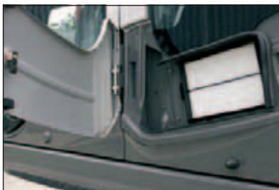
Der Frischluftfilter für die Klimaanlage wurde von der herkömmlichen Anordnung hinter dem Fahrersitz nun zur Kabinentürseite versetzt. Dies erlaubt eine leichte Reinigung und einen leichten Austausch des Frischluftfilters, genau wie beim Umluftfilter innerhalb der Kabine.
