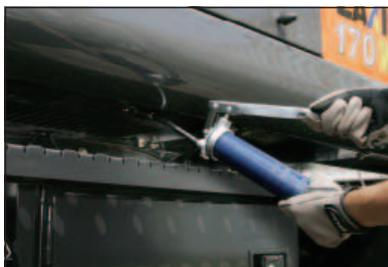
Der Ein-Punkt-Schmiernippel für das Schwenklager wurde neu konzipiert und unter der Kabine angeordnet. Dies vereinfacht Schmierung und problemlosere Wartung.
