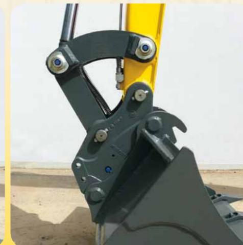
Das innovative hydraulische Schnellwechselsystem EASY LOCK ist optimal auf die Kinematik der Wacker Neuson Kompakt-bagger abgestimmt und trägt ganz entscheidend zur Verbesserung der Arbeitsprozesse bei: Heranfahren, andocken und automatisch schließen. Aufgrund der geringen Bauhöhe bleiben Ein- und Ausdrehwinkel der Schaufel voll und ganz erhalten. Ein enorm wichtiger Beitrag zu einem verbesserten Workflow.
